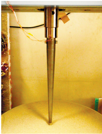
テーパー杭の室内 引き抜き試験
